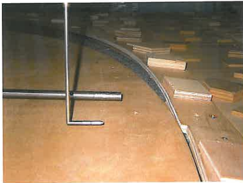
Figure 4 : Anémomètre à fil chaud et tube de Pitôt utilisés pour la mesure de la turbulence du vent à échelle réduite en soufflerie.
